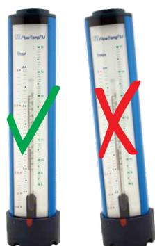
Per le misurazioni, tenere FlowTemp® M in posizione verticale sotto il getto d'acqua. La posizione inclinata può causare misurazioni errate.
